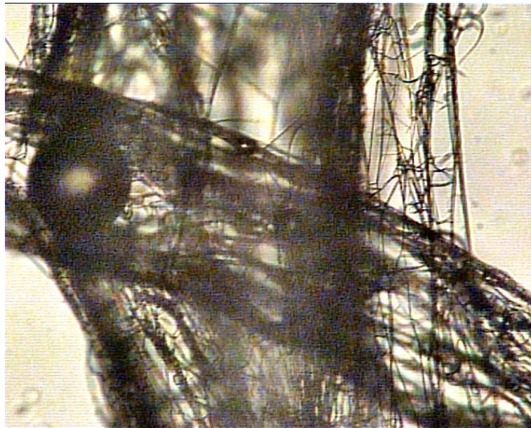
8. ábra: Elektroszinningelt szálköteg.
