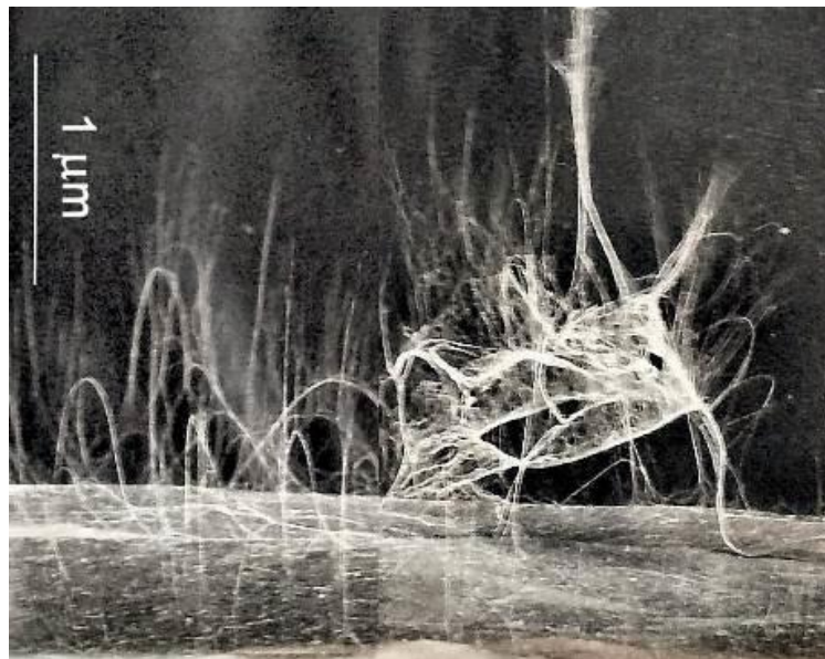
7. ábra: Elektroszinninggel előállított szálköteg.
