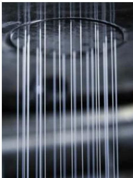
5. ábra: Olvadék spinninggel húzott szálak
