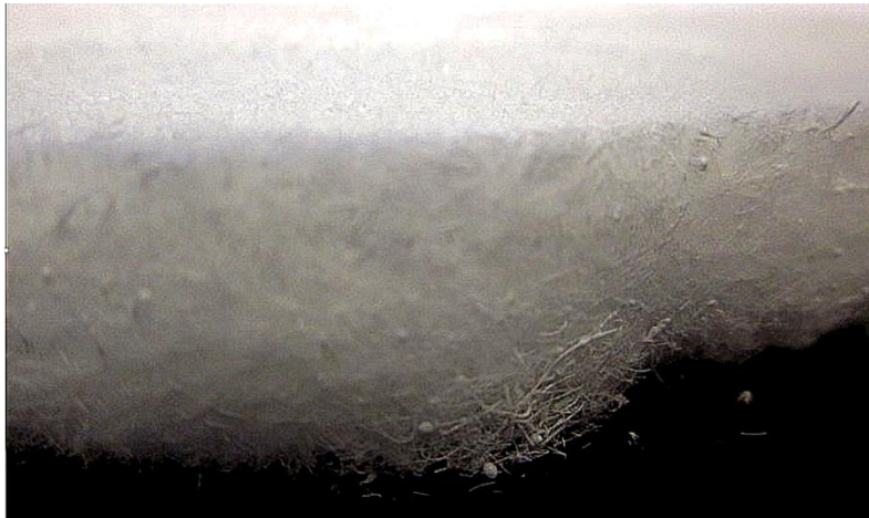
14. ábra: Centrifugális oldat spinningel készült préselt szálpaplan fényképe.
